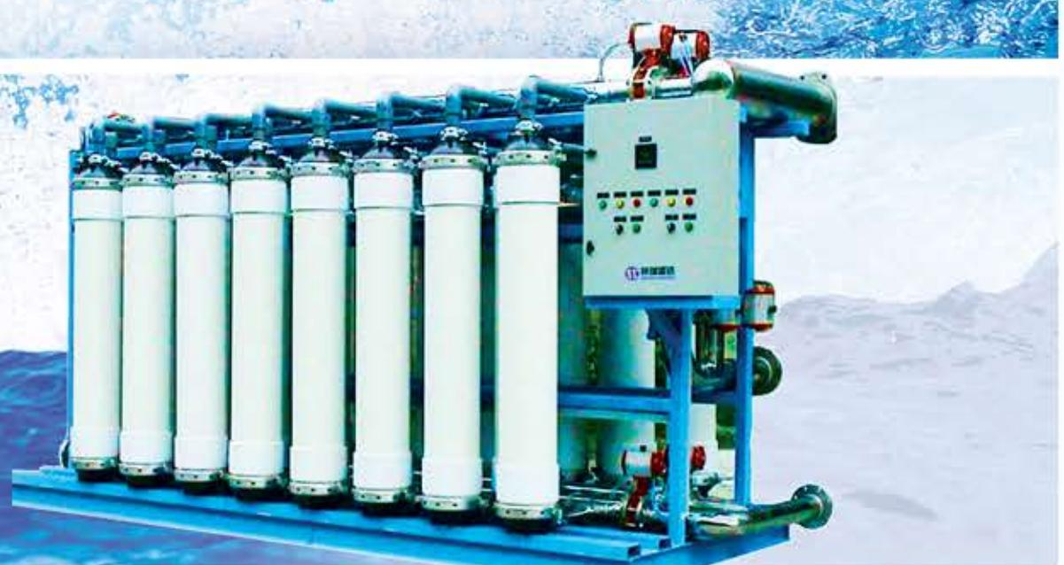
نانوفیلتراسیون فرآیند غشایی جدیدی است که خواص آن بین فرایندهای اسمز معکوس و اولترافیلتراسیون قرار دارد و در اختلاف فشار پایین (۰-۱۰ بار) قابل استفاده می‌باشد. به علت عمل نمودن در فشار پایین و بازیابی بالاتر، در این فرایند به مواد شیمیایی نیاز نبوده و پساب تولیدی فشرده و غلیظ می‌باشد. لذا هزینه حمل و نقل و دفع آن کمتر است و غشاء‌ها به کمک تجهیزات خاص به طور خودکار تمیز می‌شوند. نکته حائز اهمیت در مورد نانوفیلترها نسبت به سایر غشاهای قدرت انتخاب گری در حذف یون‌هاست.
